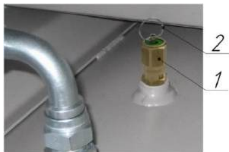
Рисунок 10 – Клапан предохранительный пружинного типа
